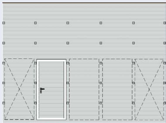
umieszczenie drzwi w bramie
